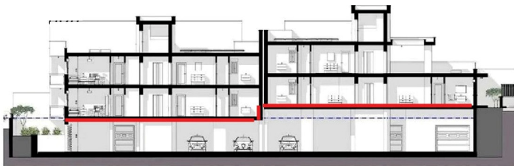
Figure 09 : Pose de membrane étanche avant la mise en œuvre de la
